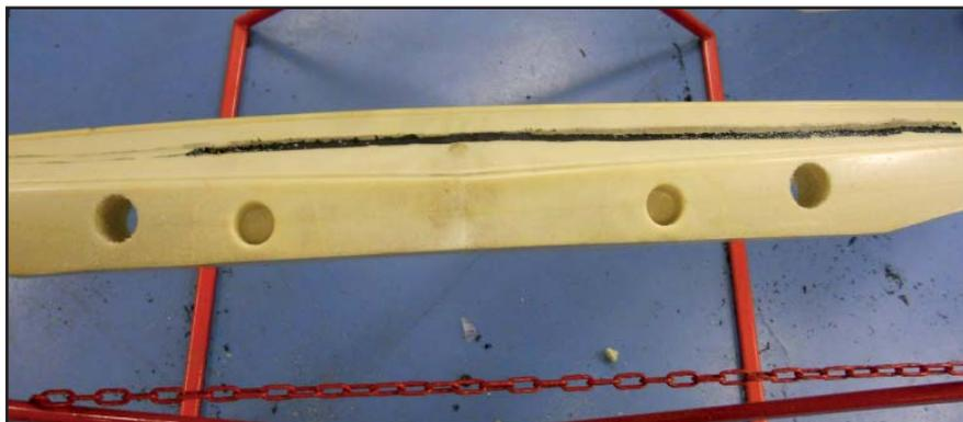
En función del tamaño de los sensores, perfore el soporte antivibratorio con una fresa de 35 mm.
