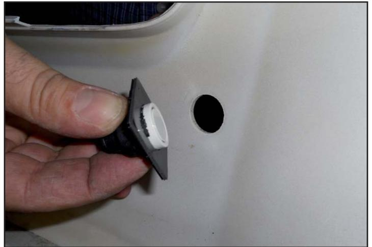
En función del tamaño de los sensores, perfora el soporte de plástico trasero con una fresa de 35 mm.
